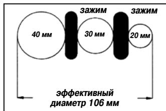
Замок ТУМ располагать со стороны кабеля, имеющего максимальный диаметр.
