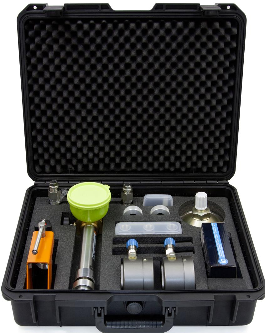
Легкий, компактный, ударопрочный кейс имеет сформованные отсеки для каждого элемента комплекса ППКД
