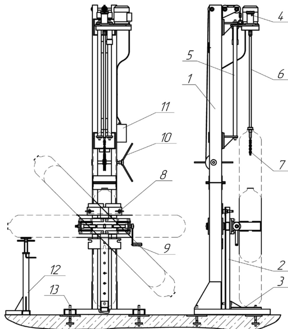
Стенд для очистки внутренней поверхности баллонов. Габаритный чертеж.
