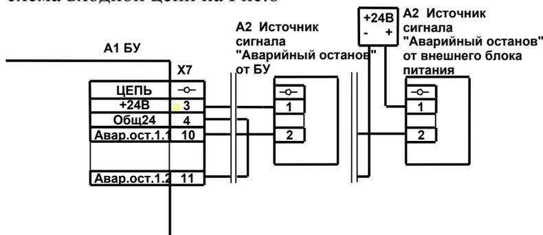
Рис.8а. Схема подключения источника сигнала "Аварийный останов"
